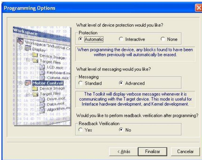
El programa guarda en memoria la última conexión configurada. De esa forma, aunque el usuario cierre el programa “Flash development toolkit”, no hace falta volver a configurar la conexión de nuevo.
