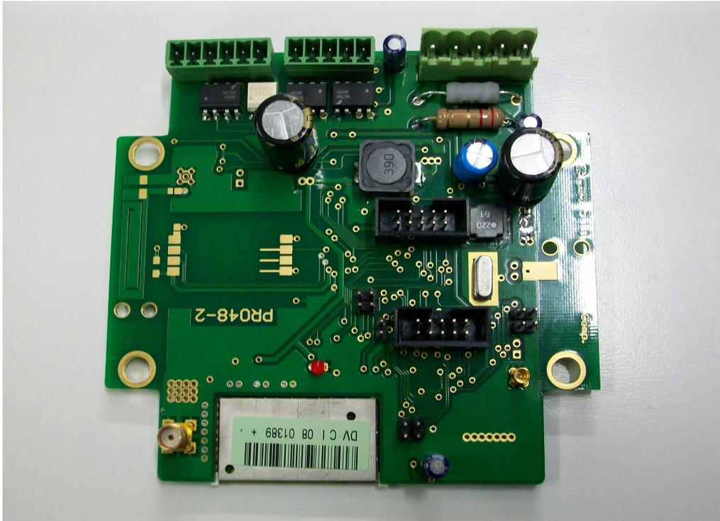
Conectamos el cable de programación y su jumper para programación.
